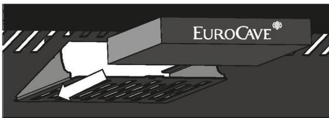
3 插入活性炭濾網 (EuroCave 公司標籤面朝您), 您可在酒櫃「附件」箱中找到此濾網, 注意請先除去塑膠保護膜。
